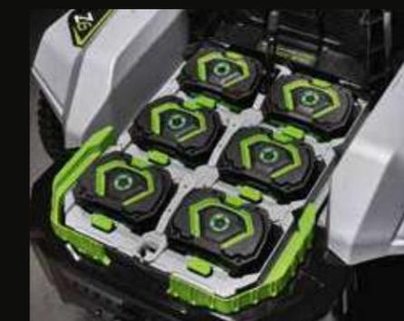
Lo Z6 è il primo trattorino a raggio zero al mondo con una piattaforma batterie completamente compatibile, alimentato da qualsiasi combinazione di batterie EGO ARC Lithium<sup>™</sup> da 56 V.
